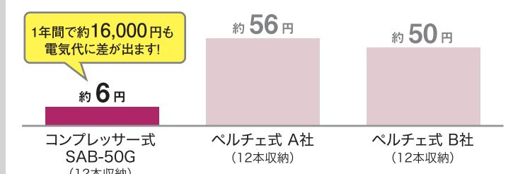
※周囲温度平均25°C、設定14°C、平均湿度70%、ワインなしで15日間測定。当社実験結果による。
